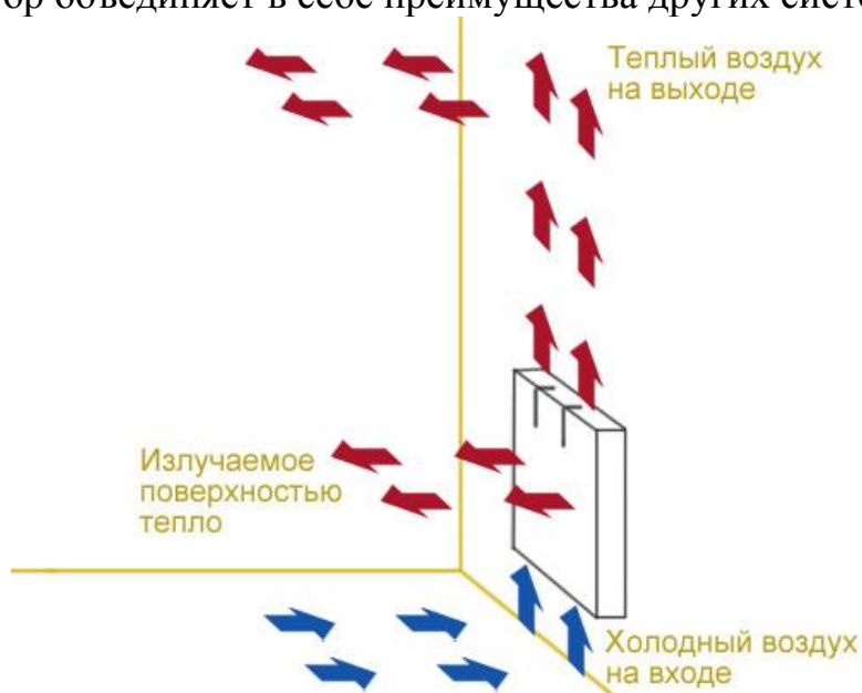
Рисунок 2 – Принцип работы электрического конвектора [2]
