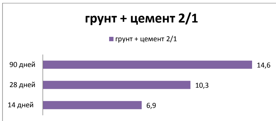
Рисунок 6- Содержание цемента 50% от массы грунта
