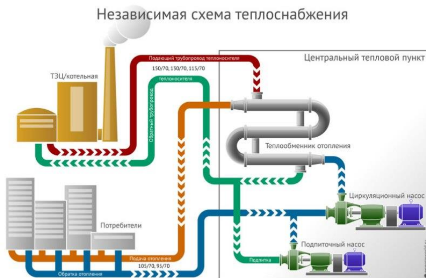
Рисунок 3 – Независимая схема теплоснабжения
